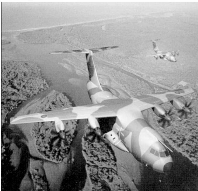
Перспективный европейский военно-транспортный самолет А-400 будет представлять собой широкофюзеляжный моноплан с высокорасположенным крылом, оснащенный четырьмя турбовинтовыми двигателями
